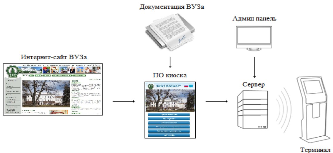
Рис. 2. Схема наполнения информационного киоска
