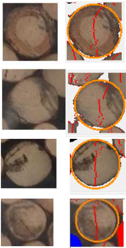
Рис. 11. Результат работы второго этапа аппроксимации окружностью
